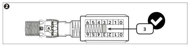
En caso necesario, utilice las válvulas de la piscina para ajustar el caudal y que el indicador esté en la posición 3.
